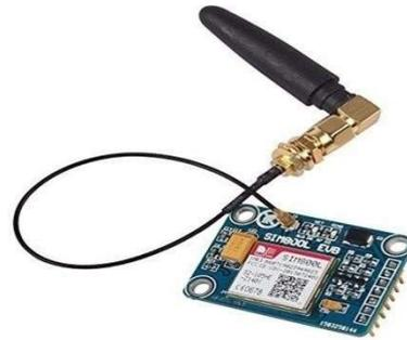
**Figure 4:** GSM module
